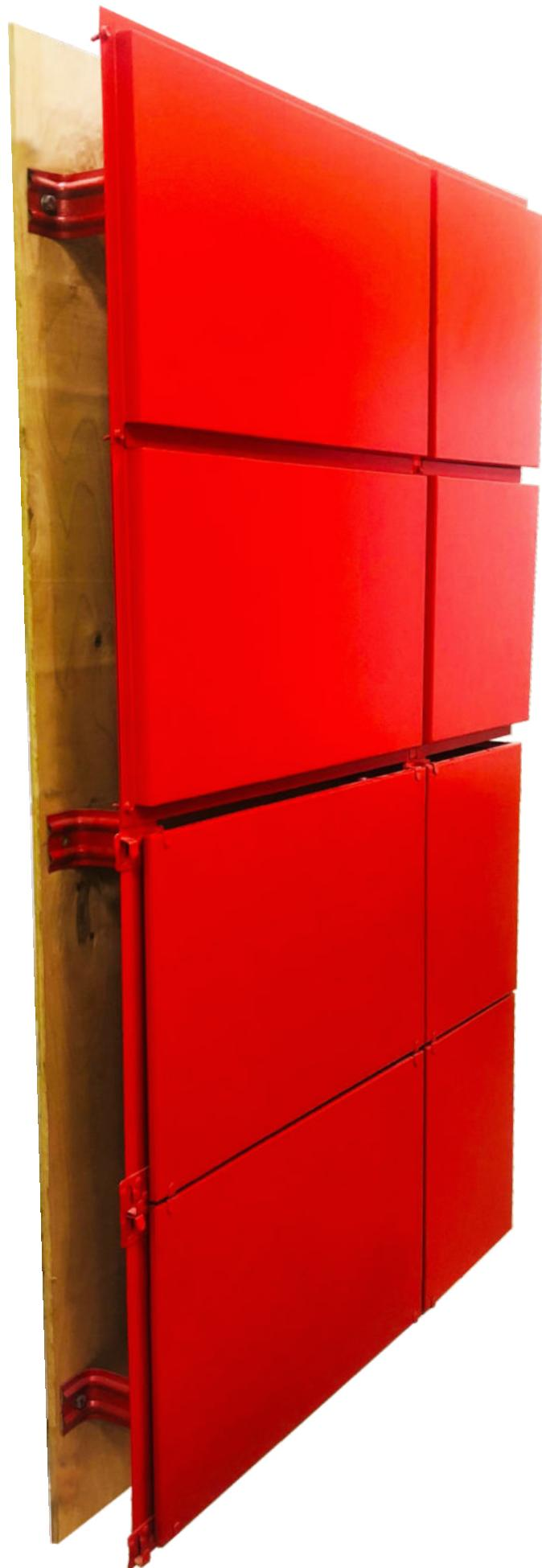
Крепежный кронштейн для вентилируемого фасада изготавливается из оцинкованной или нержавеющей стали, имеют стандартную толщину – 1,2, 1,5 или 2мм, а также рабочую длину от 50 и до 300 мм.
